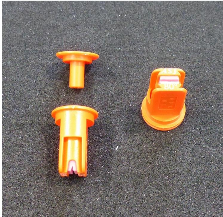
**Flachstrahldüse ASJ AFC08001,
