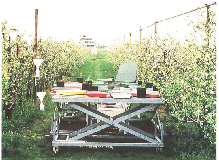
Abb. 22. Versuchsfeldaufbau für epidemiologische Arbeiten zum Apfelschorf. Sporenfalle, Fangpflanzenexposition.
