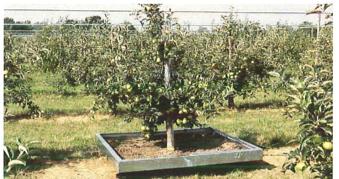
Abb. 38. Versuchsaufbau zur Freilandprüfung der Nebenwirkungen von Pflanzenschutzmitteln auf C. carnea .
