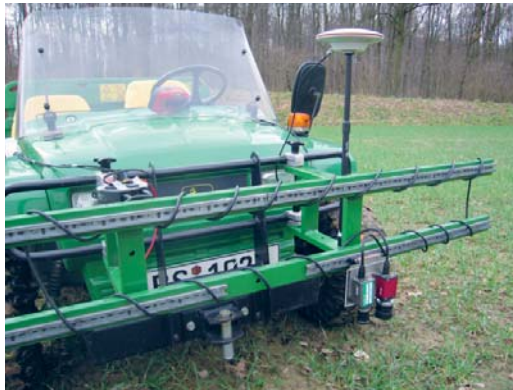
Abb. 35: Trägerfahrzeug mit zwei Kameras und GPS-Ausrüstung
