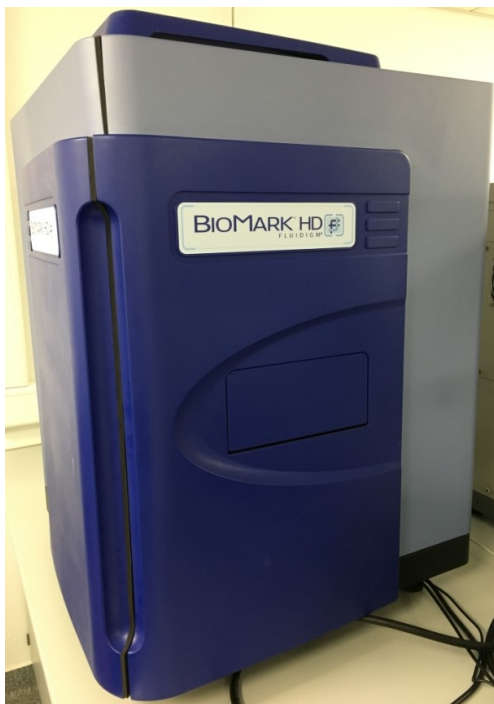
Abbildung 17: Biomark™ HD zur Genexpressionsanalyse im Hochdurchsatz
