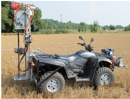
Probennahme mit Quad bis 90 cm Tiefe (System Fa. Nietfeld)
