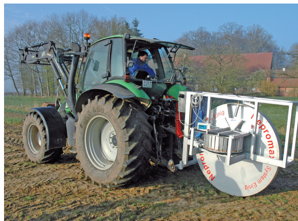
Probenahme auf Zysten aus dem Oberboden während der Fahrt (System Fa. Nietfeld)
