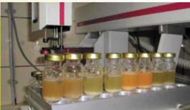
Abb. 5: Mit Hilfe der Festphasen-Extraktion (SPE) kann die Probenaufbereitung für HPLC-Untersuchungen wesentlich vereinfacht werden; außerdem wird die Verwendung organischer Lösemittel hierbei deutlich reduziert.
