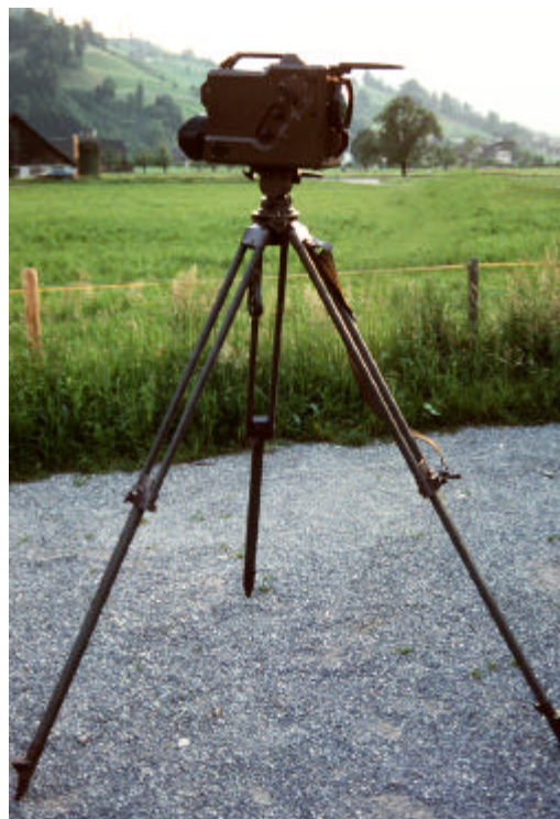
Abb. 5: Wärmebildgerät mit Laffette, R. Gago, AGFF
