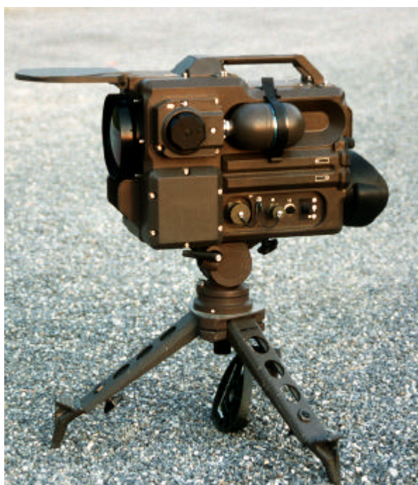
Abb. 4: Wärmebildgerät mit kleinem Stativ; R. Gago, AGFF
