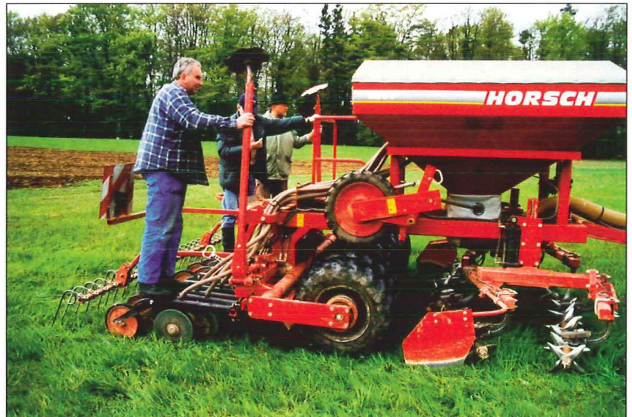
Abb. 2. Säschlitzmaschine zur Ausbringung der Melocont-Pilzgerste.
