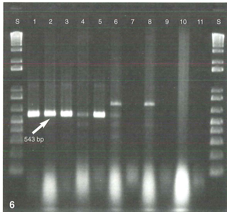
Abb. 6. PCR-Unterscheidung von „moderat anfälligen“ und „schwach resistenten“ Keimen nach künstlicher Inokulation mit Synchytrium endobioticum . Nur bei der moderat anfälligen Reaktion einer Kartoffelsorte wurden Zoosporen entlassen, die mit dem Primerpaar Kbr1 und ITS4 nachweisbar waren (Bahn 5). Kein PCR-Signal war sichtbar von der schwach resistent oder hoch resistent reagierenden Kartoffelsorte (Bahn 7 und 9), da durch die Resistenzreaktion der Kartoffel die Zoosporen abgetötet wurden und somit auch nicht schwärmen konnten. Als Kontrolle wurde die Wucherung einer hoch anfälligen Kartoffelsorte zum Schwärmen der Zoosporen verwendet (Bahnen 1 und 3). Bahnen 2, 4, 6, 8 und 10 repräsentieren die nach der 4-stündigen Wasserbehandlung extrahierten Kartoffelkeime (Bahn 6) befinden sich noch intakte Sommersori. Deshalb ist hier auch eine schwache 543 bp-DNA-Bande sichtbar. Bahn S repräsentiert den DNA-Längenstandard und Bahn 11 ist die Negativkontrolle (Wasser). Ein 750 bp großes DNA-Fragment erscheint nur bei der Keimaufarbeitung und ist unspezifisch.
