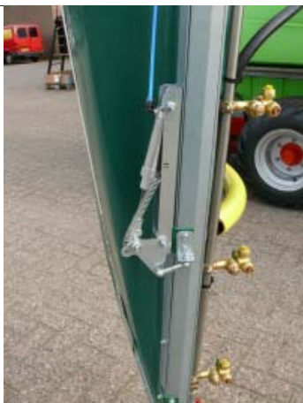
Abb. 8: Die Luftauslässe können zur Verminderung der Abdrift geschlossen werden.
