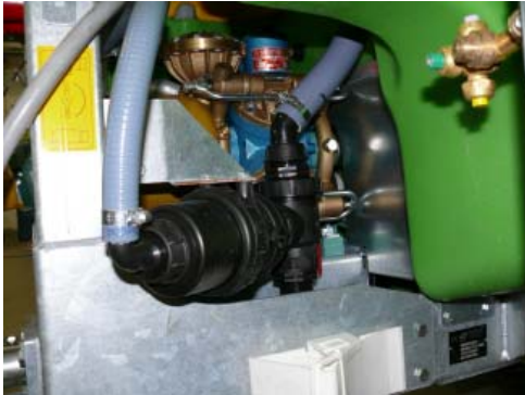
Abb. 5: Der Saugfilter ist direkt neben der Pumpe gut zugänglich.
