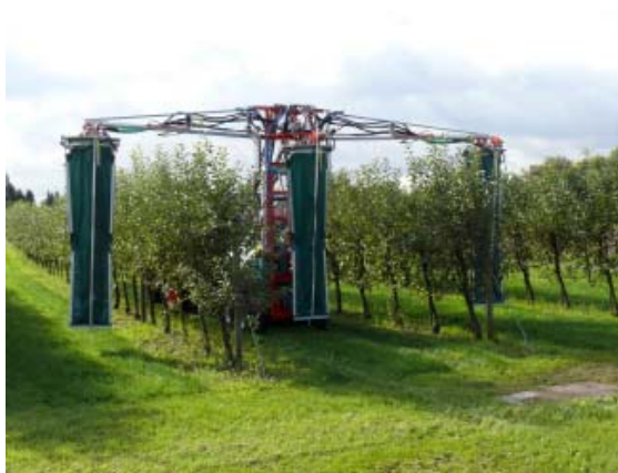
Abb. 6: Die Axialgebläse sind mittels Überzeilengestänge am Gerät montiert. Reihenweiten von 2,9 m bis 4 m sind möglich.
