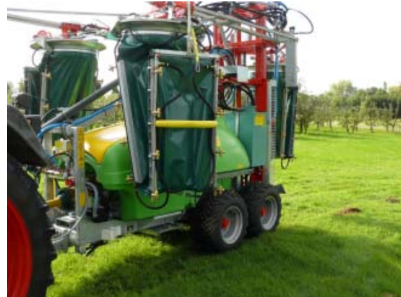
Abb. 7: Für den Transport lassen sich die Luftsäcke zusammenfallen.
