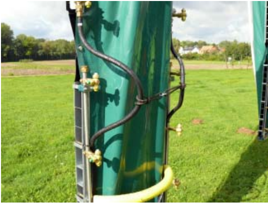
Abb. 9: Dreifach-Schwenkdüsenkörper vor dem Gebläseauslass angeordnet.
