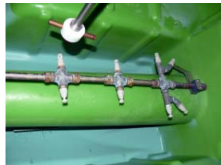
Abb. 4: Das hydraulische Druckrührwerk besteht aus Injektordüsen, welche die Radkästen anstrahlen.
