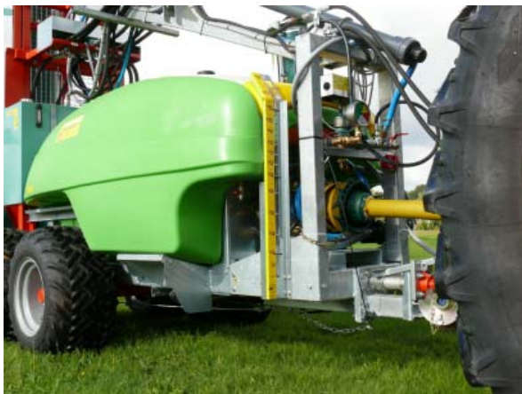
Abb. 3: Die vordere Volumenmarkierung reicht von 50 bis 1300 l und kann vom Schleppersitz aus gut eingesehen werden.
