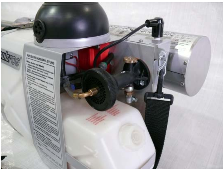
Abb. 2: Benzintank, Vergaser, Rückschlagventil und Resonator.
