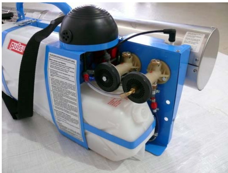
Abb. 2: Benzintank, zwei Vergaser, Rückschlagventil und Blasebalg der Startvorrichtung.
