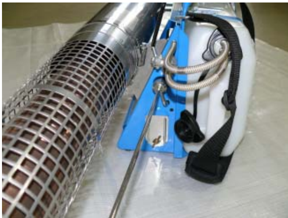
Abb. 5: Das Handventil ist griffgünstig neben dem Wirkstoffbehälter angeordnet. Der Membranzylinder der Abschaltautomatik und das Batteriefach sind unterhalb des Nebelrohres platziert.
