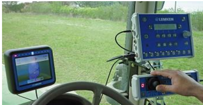
Abb.8: Bedieneinrichtung LEMKEN Ecospray und EcoControl in der Fahrerkabine.
