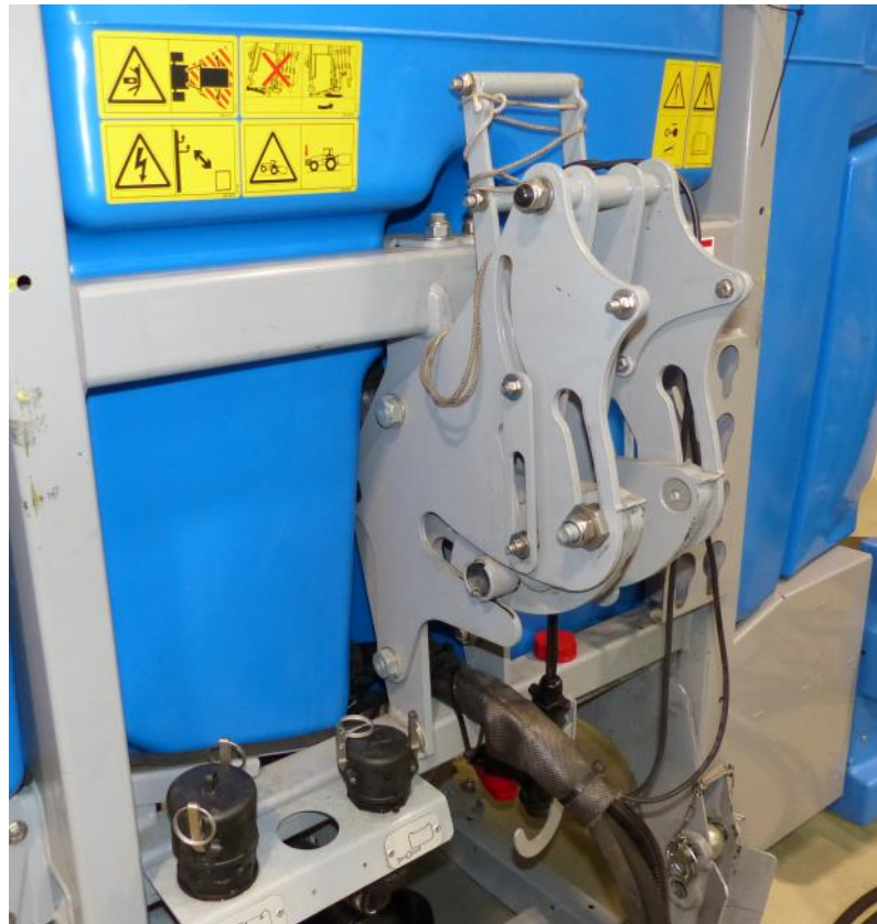
Abb.2: Verbindungseinrichtung des Oberlenkers an der Schnellkupplungseinrichtung.
