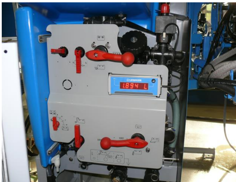
Abb.6: Linke Geräteseite mit Bedienzentrum.
