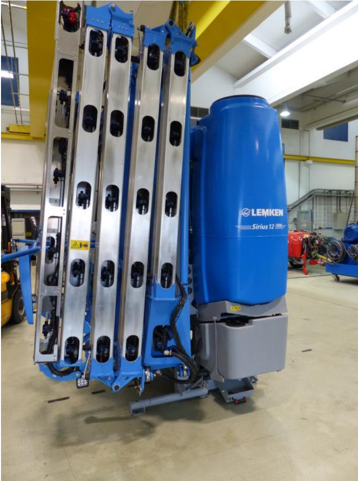
Abb.5: Rechte Geräteseite mit eingeklapptem Spritzgestänge aus Aluminium.
