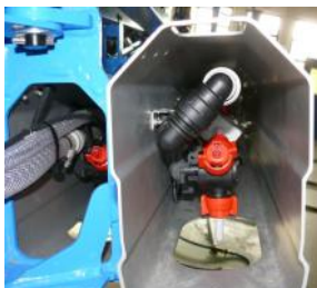
Abb.3: Im Aluminiumprofil geschützte Düse.
