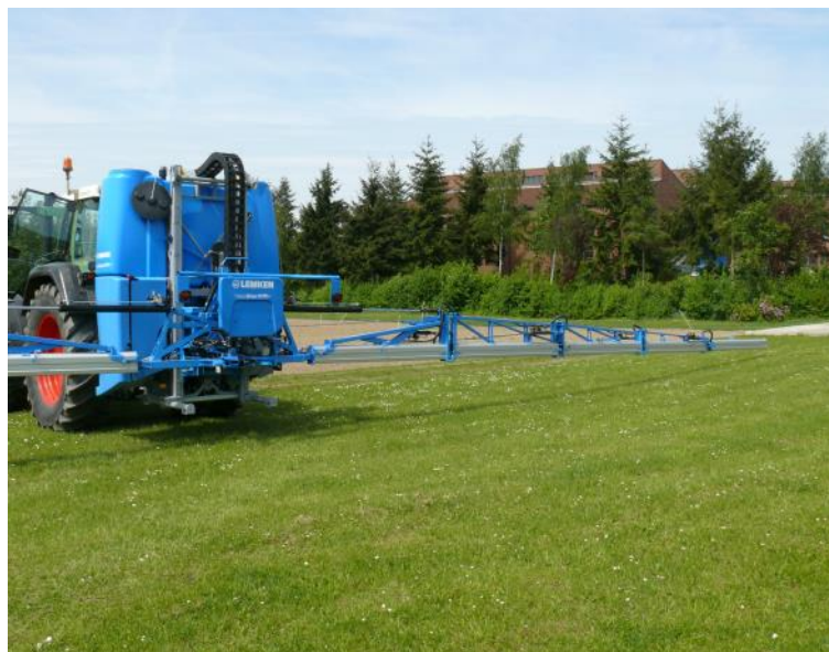
Abb.4: Ausgeklapptes Gestänge und Hubeinrichtung (bei optisch identischem Modell 10/1900).
