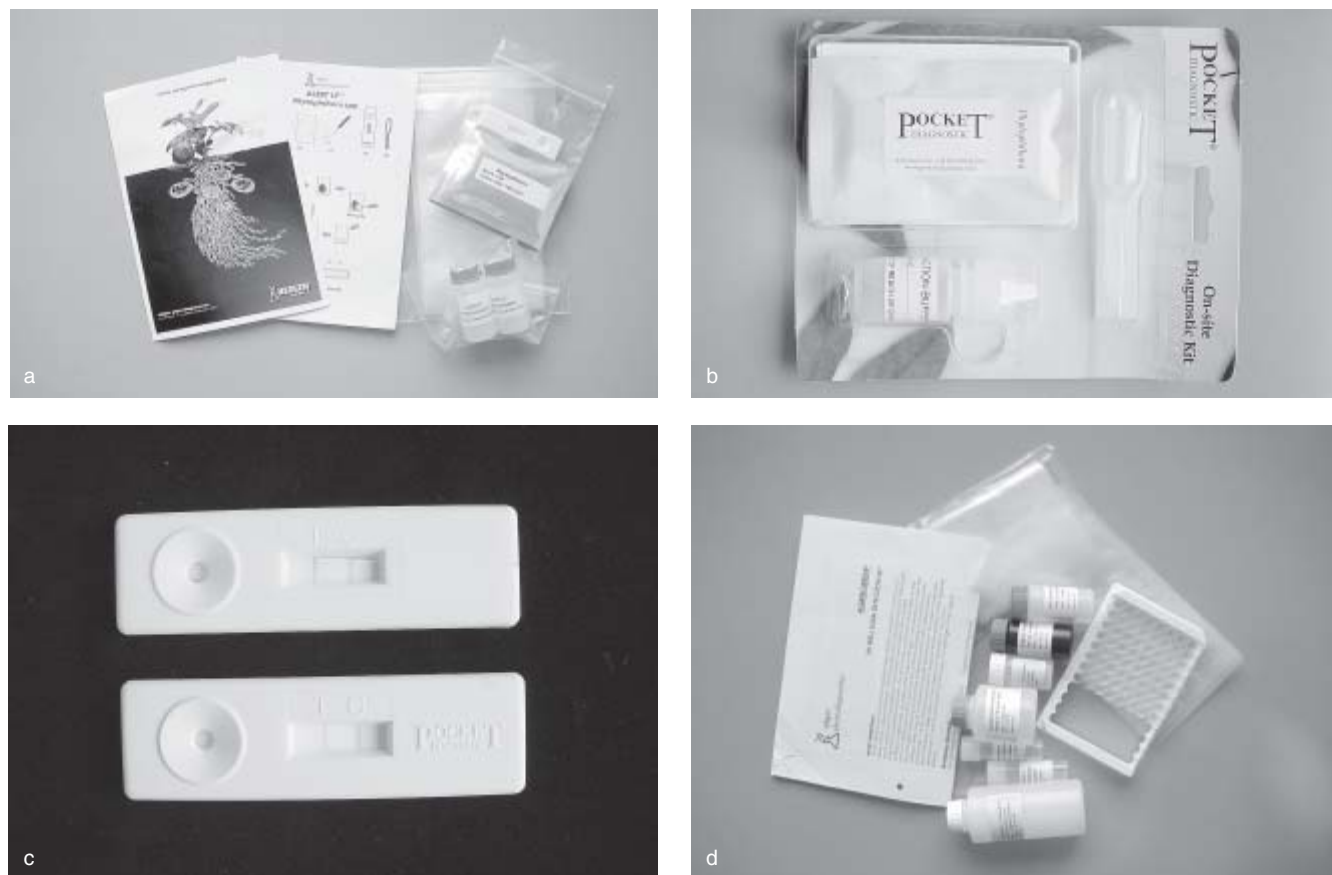
Abb. 1. Die in den Untersuchungen verwendeten Testkits: a – ALERT-LF™ Phytophthora spp. (Neogen, UK); b – POCKET DIAGNOSTIC® Phytophthora (Central Science Laboratory, UK); c – Teststreifen der on-site Kits (oben: ALERT-LF™, unten: POCKET® DIAGNOSTIC); d – AGRISCREEN® LABORATORY IMMUNOASSAY Phytophthora (Neogen, UK)
