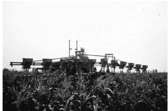
Abb. 6. Stelzenschlepper mit Granulatstreuerausrüstung (GANDY-Hopper) zur Maiszünslerbekämpfung.
