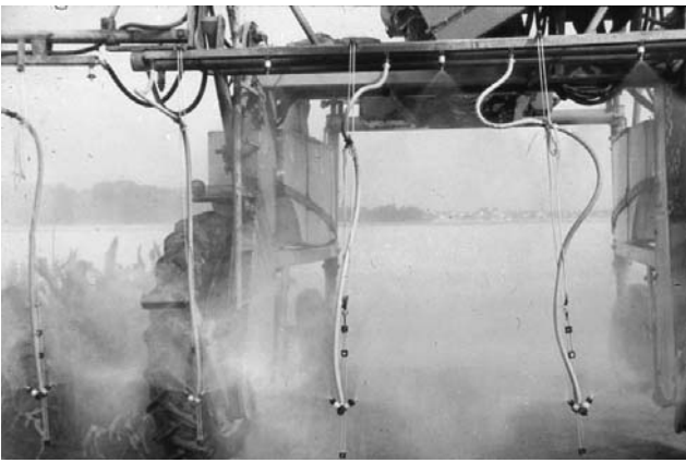
Abb. 5. Spritzbild des Stelzenschlepper mit Spezialspritzgestänge zur Maiszünslerbekämpfung.
