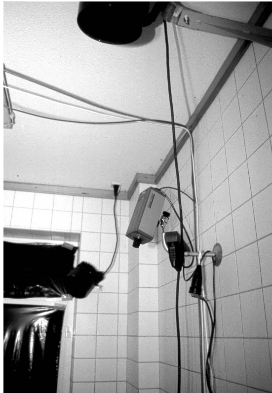
Abb. 6 Videokamera mit Wandhalterung und den beiden Infrarot-Scheinwerfern zur Ausleuchtung des Open-Fields. Im Hintergrund ist die mit lichtdichter Folie verklebte Glastür zu sehen.
