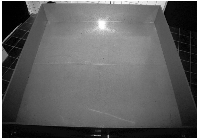
Abb. 4 Blick in das Open Field. In den Wänden sind kurz über dem Boden die Öffnungen für die Lichtschranken zu sehen. Die Glastüren des Untersuchungsraumes sind mit lichtundurchlässiger Folie abgeklebt.
