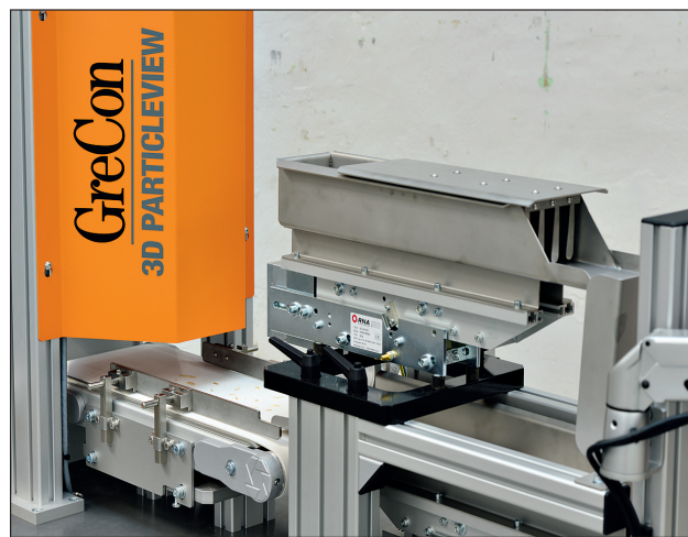
Abbildung 3 Spanvereinzelnung mittels Vibrationsrinnen, Platzierung der Späne für die Vermessung auf einem Förderband Fotos: Jürgen Bartels
