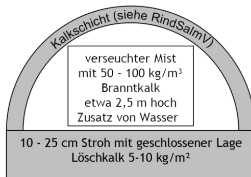
Abbildung 1: Schematischer Aufbau einer Festmistpackung mit Festmist und gekörntem Branntkalk 9, 12 :
