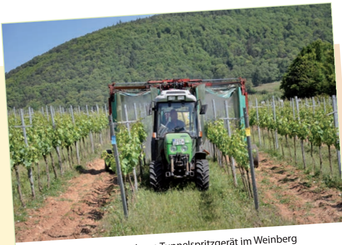
Versuchsapplikation mit einem Tunnelspritzgerät im Weinberg Test application in an experimental vineyard with a tunnel-sprayer
