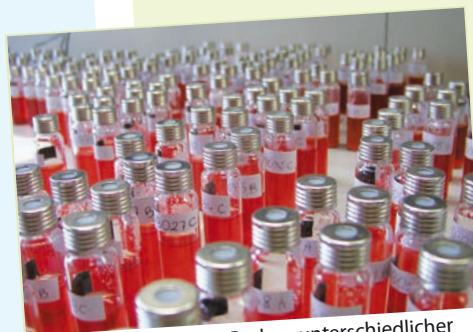
Abb. 10: Aufbereitete Proben unterschiedlicher Erdbeer-Zuchtklone für die Hochdurchsatz-Aromaanalyse mittels GC-MS-TOF
