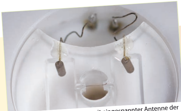
Abb. 14: Antennenhalterung mit eingespannter Antenne der Dörrobstmotte ( Plodia interpunctella ). Die beiden Enden des Fühlers sind über Ringlösung mit den ableitenden Elektroden verbunden, die zu einem Verstärker führen
