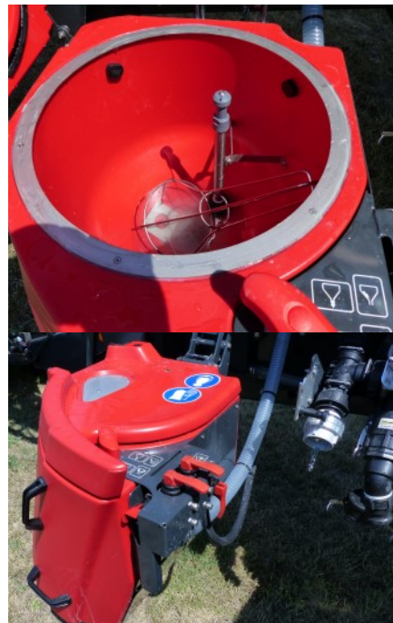
Abb.3/4: Ausgeklappte Einspülschleuse auf der linken Geräteseite. Zusätzlicher Drahtkonus zur Gebindespülung (oberes Foto).
