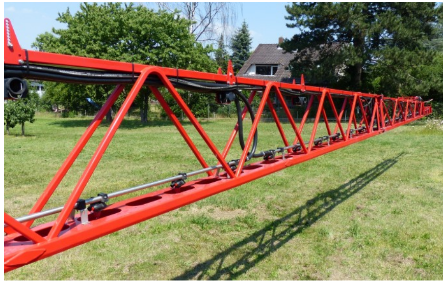
Abb.5: Ausgeklapptes Gestänge mit Düsen in geschützter Position.
