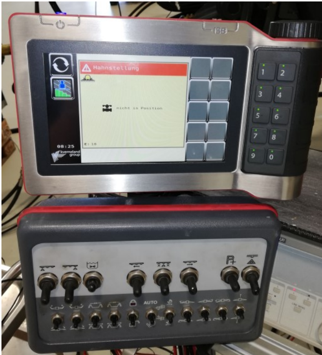
Abb.7: Tellus GO Terminal mit Schaltbrett.
