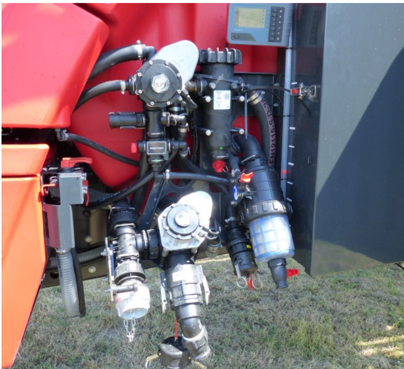
Abb.6: Bedienzentrum und Einspülschleuse auf der linken Geräteseite.
