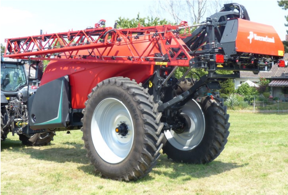
Abb.2: Gestängehubeinrichtung und seitlich gefaltetes Gestänge.
