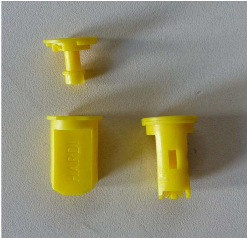
Doppelflachstrahldüse Hardy MINIDRIFT DUO 110-02
