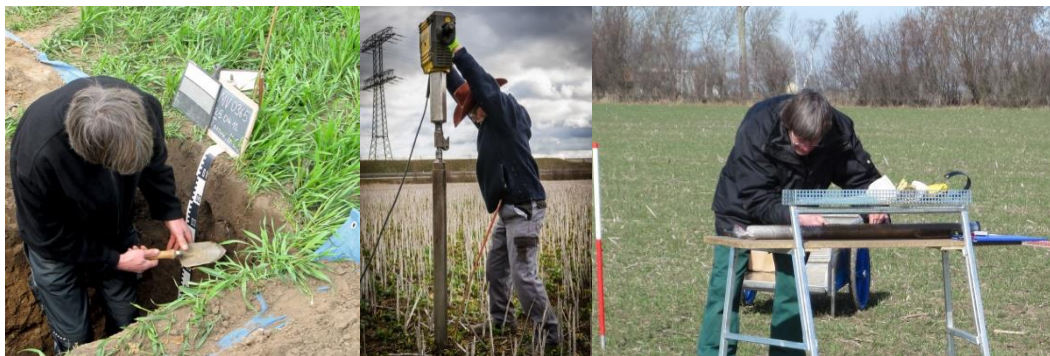
Abbildung 2-4: Bodenprobenahme der Bodenzustandserhebung Landwirtschaft: (a) Stichzylinderentnahme in der Profilgrube, (b) Bohrkernentnahme mittels Rammkernsondierung, (c) Zerteilung des Bohrkernes mit Berücksichtigung von Stauchungen und Streckungen
