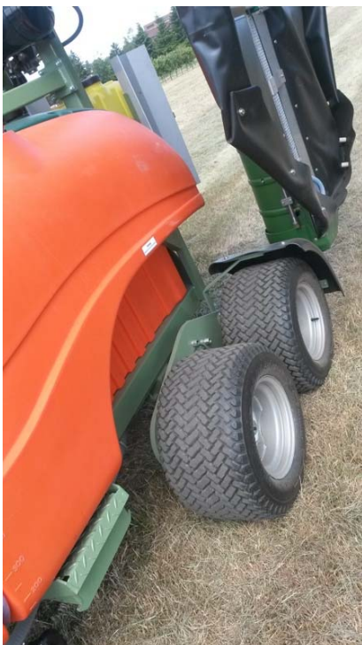
Abb. 2 und 3: Das Fahrgestell ist mit hydraulischer Lenkdeichsel und Tandemfahrwerk ausgestattet. Die Pumpe befindet sich auf dem Drehgelenk der Deichsel.
