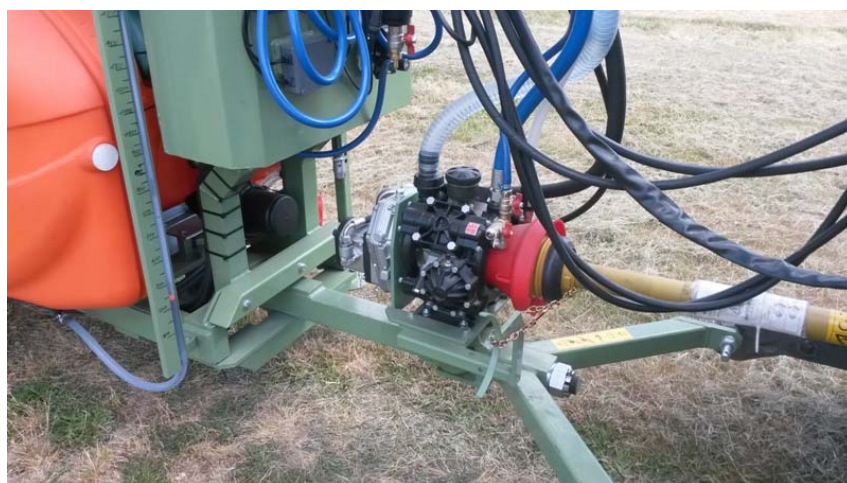
Abb. 2 und 3: Das Fahrgestell ist mit hydraulischer Lenkdeichsel und Tandemfahrwerk ausgestattet. Die Pumpe befindet sich auf dem Drehgelenk der Deichsel.
