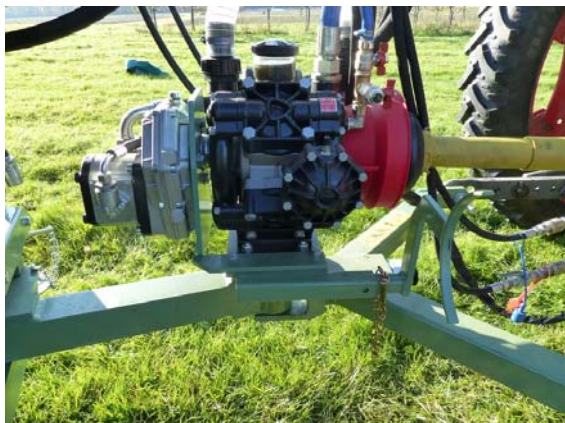
Abb. 6: Die Pumpe AR 185 BP ist auf dem Drehgelenk der Deichsel montiert und folgt bei Kurvenfahrten dem Schlepper ohne ein Abknicken der Gelenkwelle.
