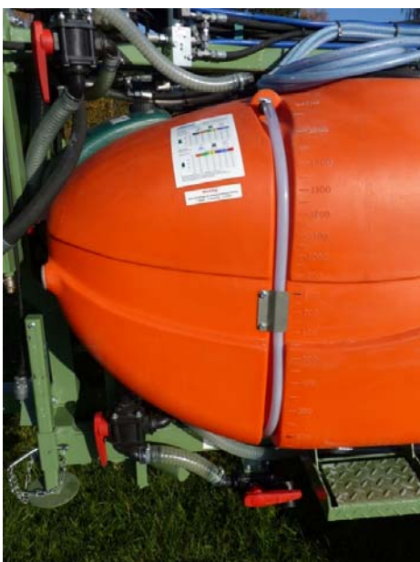
Abb. 4: Der Füllstand wird über einen Füllstandschlauch angezeigt.
