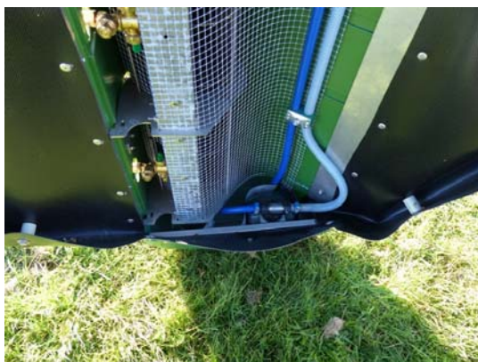
Abb. 7 und 8: Innenansicht einer Spritzwand, Gebläsegehäuse aus Polyethylen, Spritzschutz aus Gewebefolie. Im Sumpfbereich wird die Flüssigkeit mit einem Injektor abgesaugt. Entleerung des Sumpfes über Ablassschraube.
