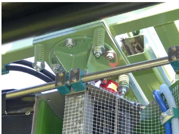
Abb. 9 und 10: Die Spritzwände sind beweglich am Tragrahmen aufgehängt. Zum Erreichen der oberen Düsen ist das Gerät mit einer Leiter ausgerüstet, die leicht mitgeführt werden kann.
