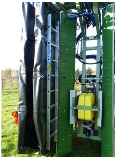
Abb. 9 und 10: Die Spritzwände sind beweglich am Tragrahmen aufgehängt. Zum Erreichen der oberen Düsen ist das Gerät mit einer Leiter ausgerüstet, die leicht mitgeführt werden kann.
