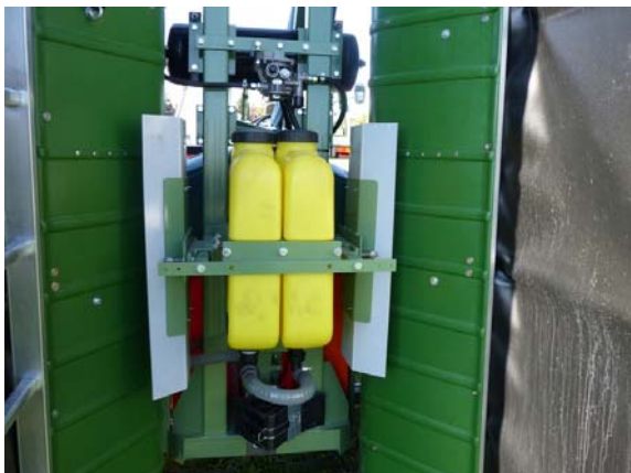
Abb. 5: Die zusätzlichen Spülwasserbehälter sind von hinten zugänglich.
