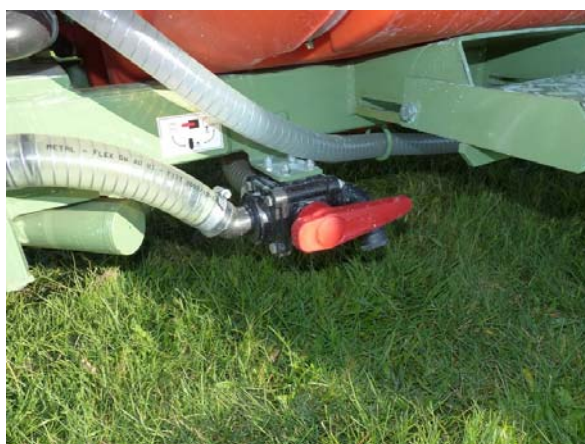
Abb. 11: Saug- und Ablassarmatur an der linken Geräteseite.
