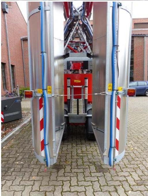
Abb. 10, 11 und 12: Reflektortraggestell und Sumpfbereich (oben). Reflektoren in Transportstellung mit hinten angeordneten Düsenrohren (links).
