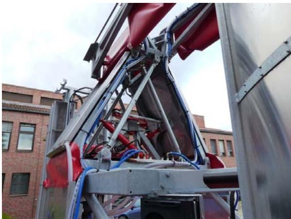
Reflektoren (zwei) mit einem Rahmen aus Stahlnormprofilen (feuerverzinkt) mit Aluminiumblechen beplankt. Am Boden ein Sumpfbereich mit Lochblech (6 mm Löcher) zur Abfilterung grober Partikel (Blätter, Blüten, Äste). Je Reflektor ein Düsenrohr an
