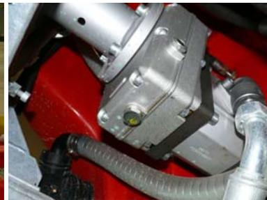
Abb. 6 und 7: Tangentialgebläse mit hydraulischem Antrieb.
