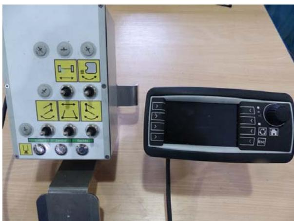
Abb. 14: Terminal mit Flüssigkristallanzeige und Schaltkasten für die Hydraulikfunktionen sowie zur Gebläsedrehzahlsteuerung
