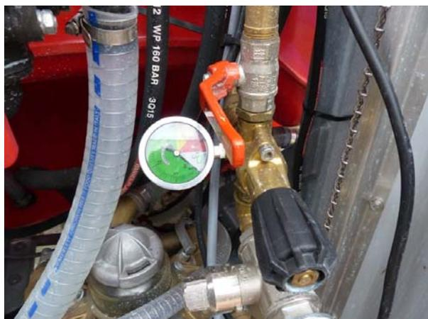
Abb. 15: Der Druck an den Injektoren zur Absaugung der Sumpfe kann separat verstellt und angezeigt werden.
