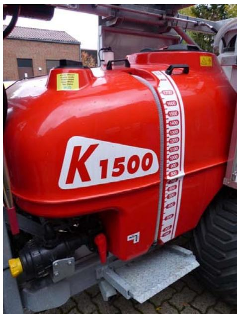
Abb. 4: Behälter aus Polyester mit 1500 l und seitlicher Skala.
