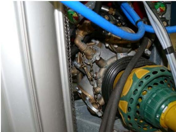
Vierkammer-Membranpumpe Comet IDS 1400. Antrieb über Teleskop-Gelenkwelle mit Zapfwellen-Normprofil und Durchtrieb für die angeflanschte Hydraulikpumpe.
