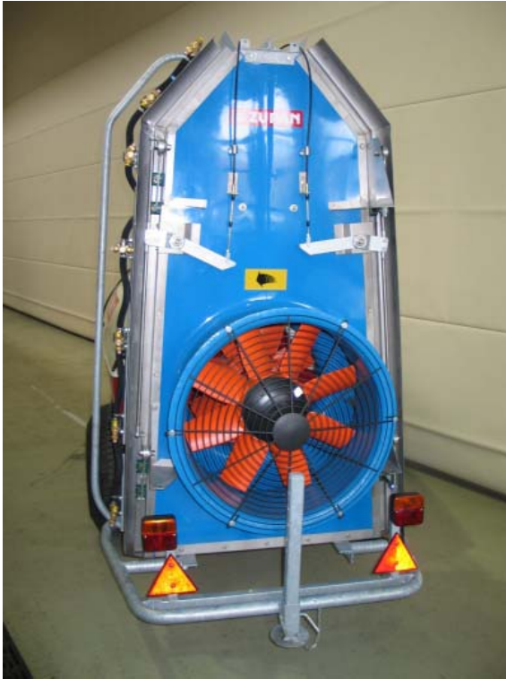
Abbildung 4: Doppel-Axialgebläse mit Luftleitapparat und Luftmengenregulierung
