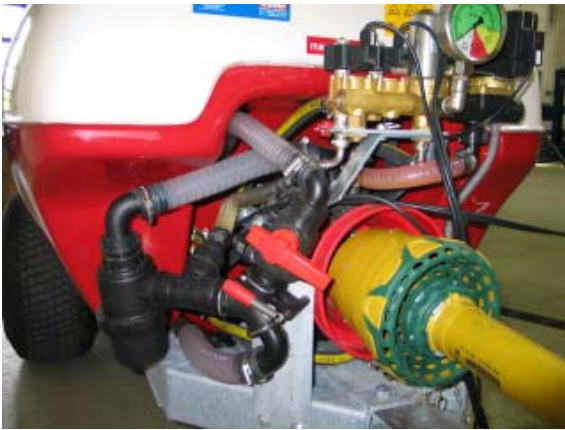
Abbildung 10: Saug- und Druckfilter im Bereich der Pumpe
