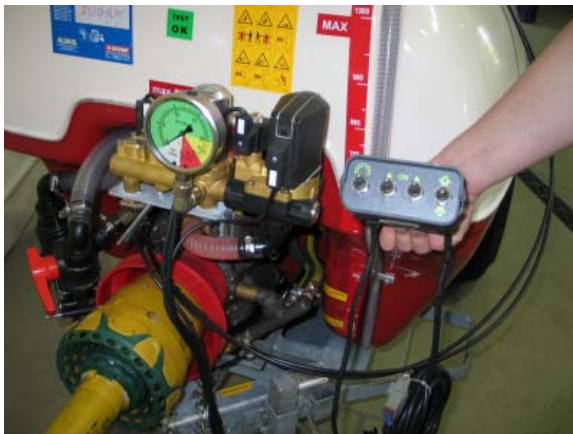
Abbildung 11: Elektrische Armatur mit Fernbedienung. Das Manometer mit 100 mm Durchmesser kann vom Fahrerplatz aus gut abgelesen werden.
