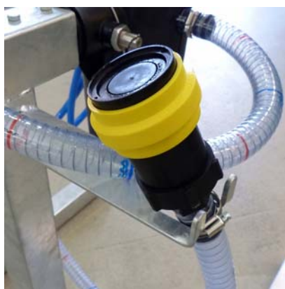
Abb. 2: Der mittels „ezi-connect Kappe“ verschlossene Behälter wird durch das System gehalten und dicht verschlossen. Durch Drehen des Dosierhandgriffes kann das PSM mehr oder weniger schnell eingesaugt werden.
