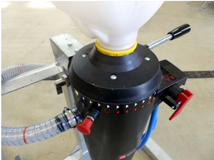
Abb. 2: Der mittels „ezi-connect Kappe“ verschlossene Behälter wird durch das System gehalten und dicht verschlossen. Durch Drehen des Dosierhandgriffes kann das PSM mehr oder weniger schnell eingesaugt werden.
