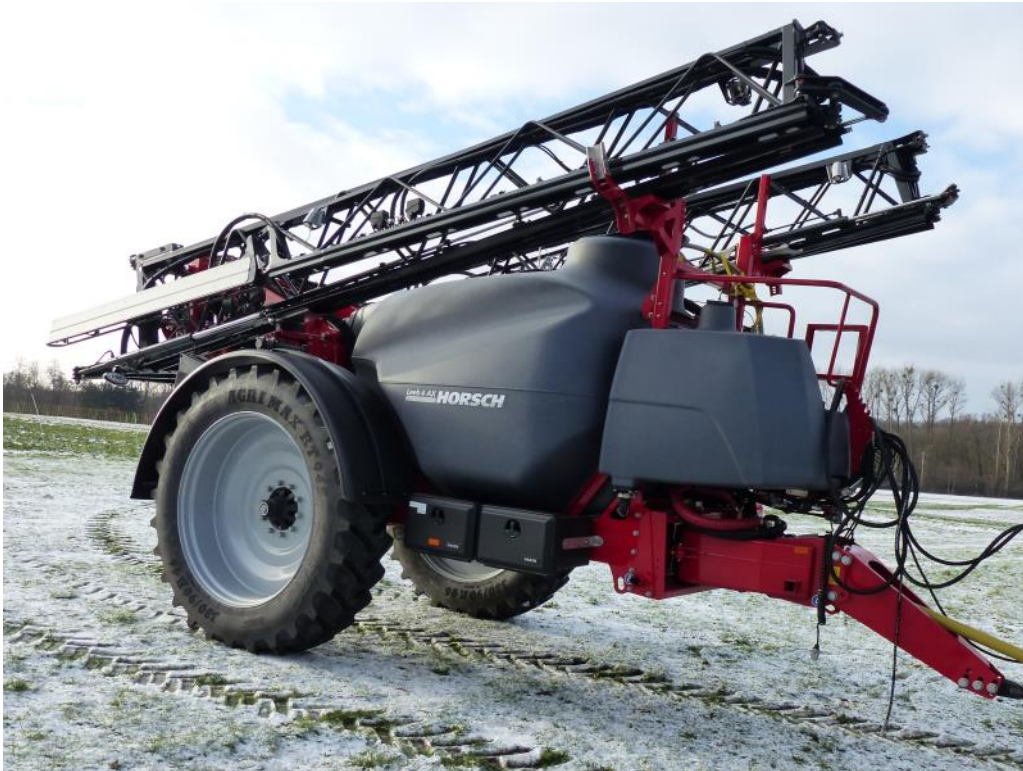
Abb.2: Rechte Seite mit geklapptem Gestänge, Stauboxen und Reinigungwassertank (über der Deichsel).
