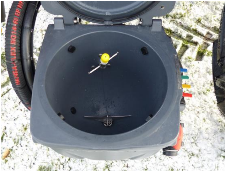
Abb.6: Einspülschleuse aus Kunststoff. Mit Wanddüsen und Rotationsdüse.
