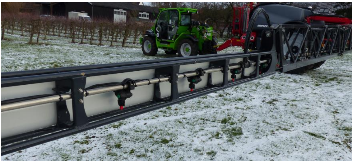
Abb.3: Äußeres Gestängesegment mit gutem Düsenschutz und Hindernisausweichfunktion.
