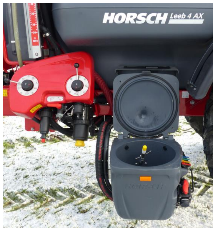
Abb.5: Linke Geräteseite mit Einspülschleuse, Bedienzentrum mit Füllanschlüssen und Tankinhaltsskala.
