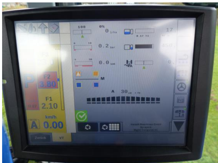
Abb.7: Müller „Touch 800 Terminal“ Bedieneinrichtung zur Anbringung in der Fahrerkabine.
