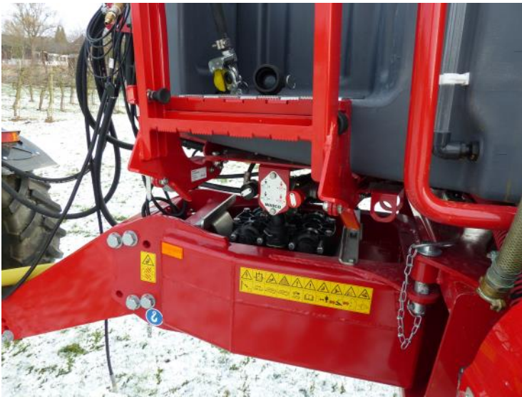
Abb.4: Lenkdeichsel mit Pumpe und Lenkarretierung (Bolzen rechts).
