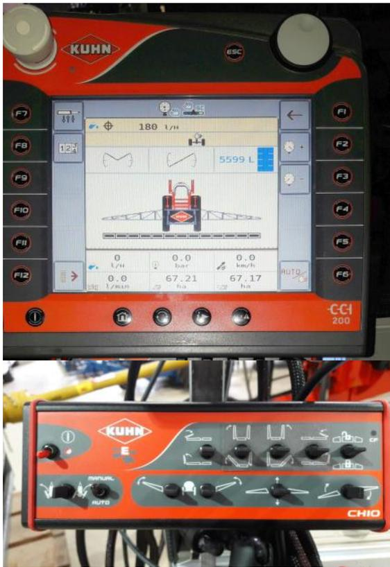
Abb.6: Anzeige- und Schalteinheit (CCI200). Unten und rechts verschiedene Schalttafeln (CH10 und ISOCLICK) für die Hydraulikfunktionen.
