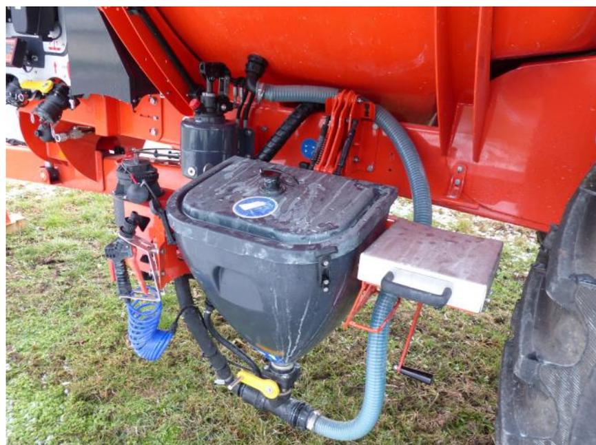
Abb.5: Linke Geräteseite mit ausgeklappter Einspülschleuse.
