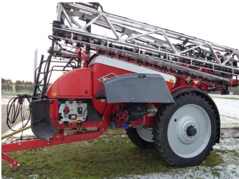
Abb.3: Linke Geräteseite mit Bedienzentrum und Einspülschleuse.
