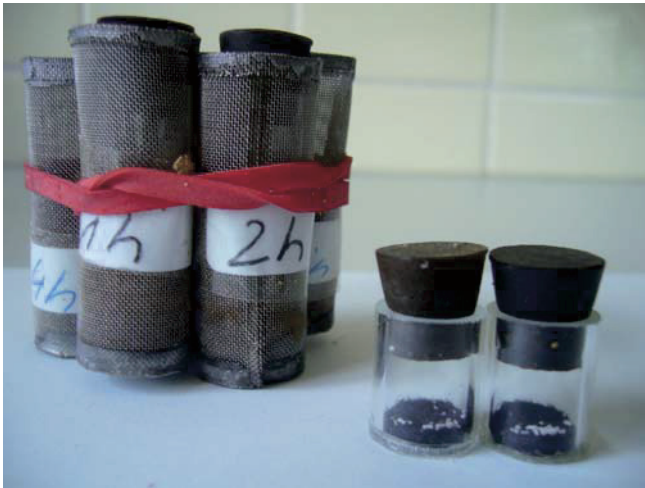
Abb. 2. 50 Brotkäfer Eier auf schwarzem Filzstoff in kleinen Glasgefäßen (Ø 13 mm, Länge 15 mm), auf der Unterseite mit einer aufgeklebten Nylongaze mit 0,2 mm Maschenweite und auf der anderen Seite mit einem Gummistopfen verschlossen (rechts im Bild); für die Kältebehandlung wurden diese Glasgefäße in kleine runde Drahtgazekäfige (Ø 16 mm, Länge: 50 mm) mit 5 ml Weizenkleie gegeben. Diese Drahtgazekäfige wurden auch für Larven, Puppen und Imagines der Brotkäfer und die Brutstadien der Motte verwendet.
