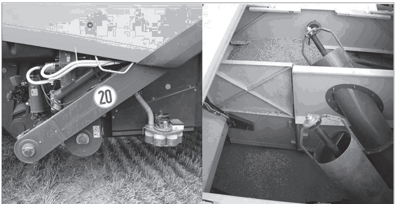
Abb. links: Versuchsaufbau am Elevator der Versuchsmaschine CLAAS LEXION 570, rechts: geteilter Korntank mit Zwillingsbefüllschne-
