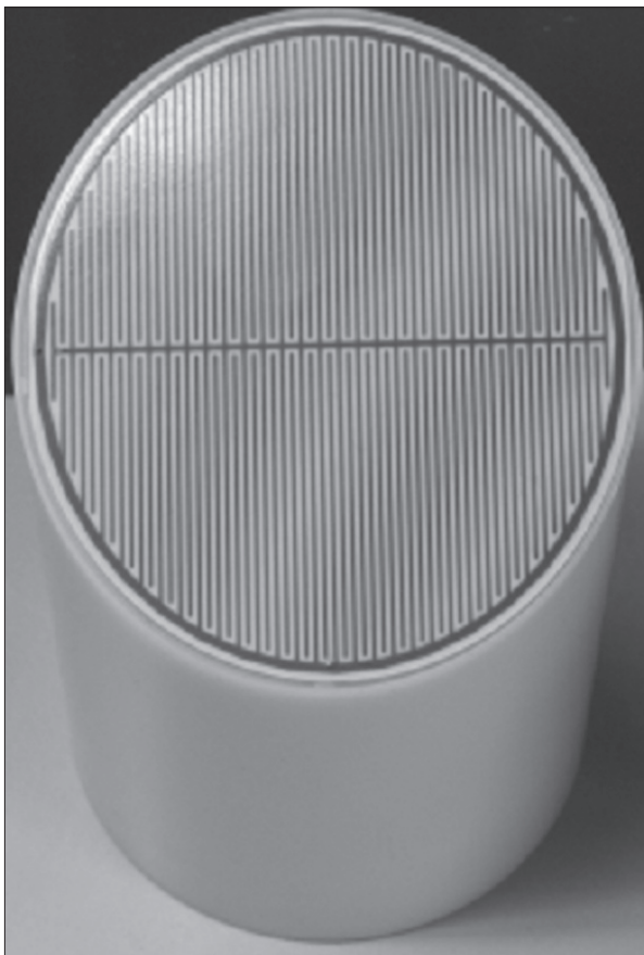
Abb. 2 : Prototyp eines kapazitiven Sensors. Die eingeschlossenen Leiterbahnen bilden eine Kammstruktur. Die Sensorfläche wurde für einen besseren Regenablauf schräg zur Horizontalen angeordnet und mit einer hydrophilen Oberflächenbeschichtung versehen.
