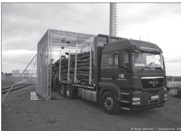
Abb. 1: Pulkausleseverfahren im RFID-Gate
