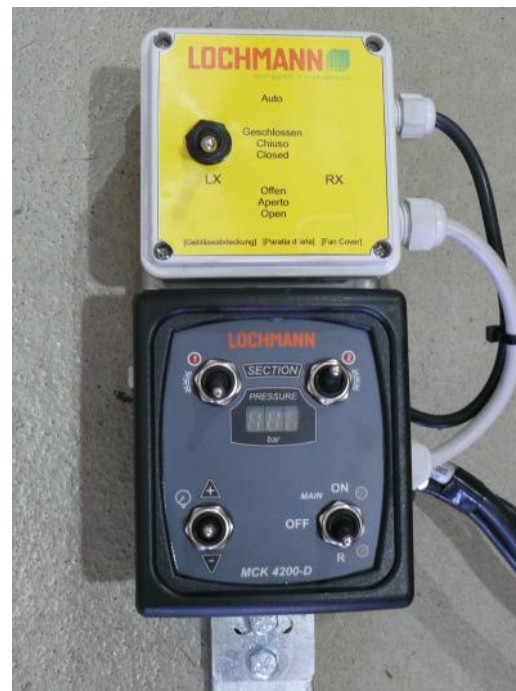
Abb.5: Fernbedienung zum Schalten der Düsen und zur Einstellung des Spritzdrucks. Zusätzlich die optionale Schaltbox (gelb) zum Verfahren des Luftabschirmbleches.
