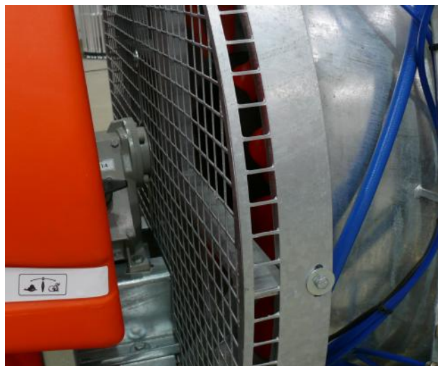
Abb.3: Lufteinlass und Getriebe des Rotors.
