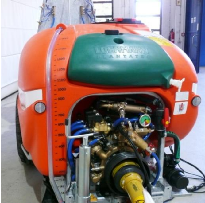
Abb.4: Zapfwellengetriebene Pumpe und Tank mit Inhaltsanzeiger.
