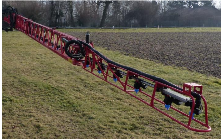
Abb.5: Ausgeklapptes Gestänge mit Düsen in geschützter Position.
