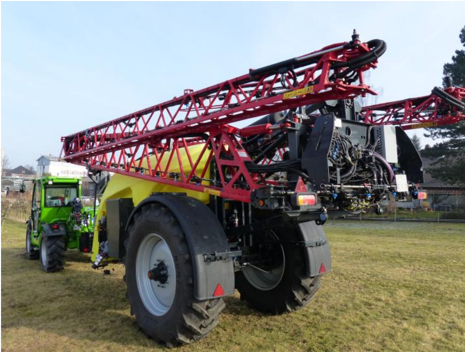
Abb.2: Gestängehubeinrichtung und seitlich gefaltetes Gestänge.
