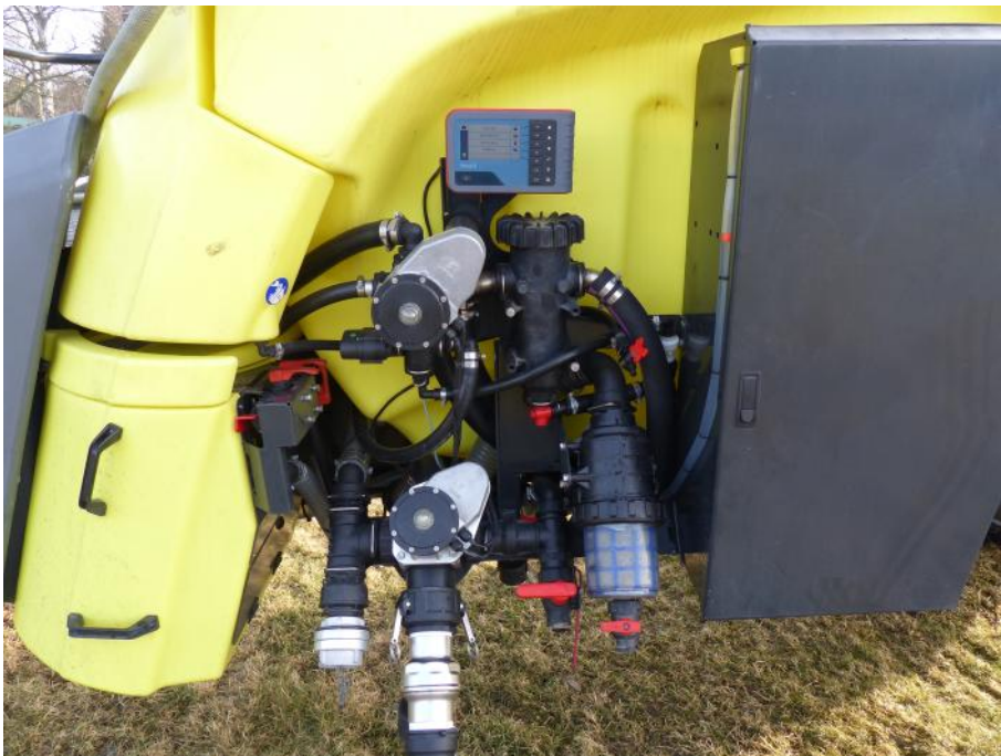
Abb.6: Bedienzentrum und Einspülschleuse auf der linken Geräteseite.
