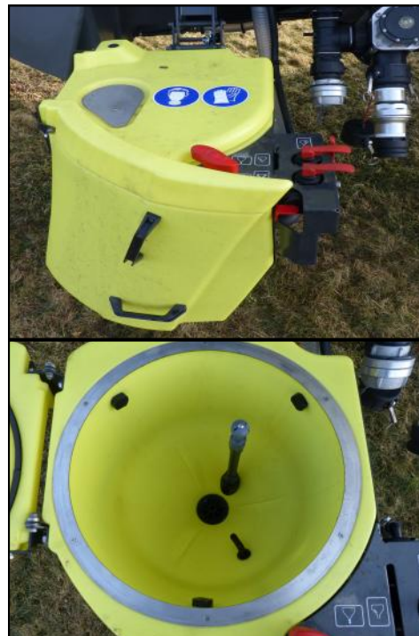
Abb.3/4: Ausgeklappte Einspülschleuse auf der linken Geräteseite.
