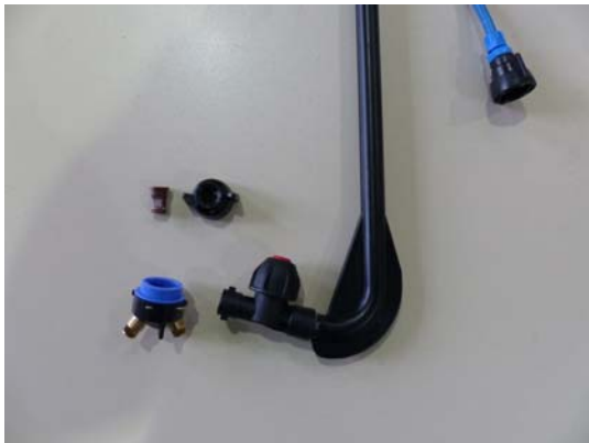
Abb. 5: An das Dropleg UL mit Membranventil passen sowohl TwinSpray-Kappe wie auch eine Standardkappe.
