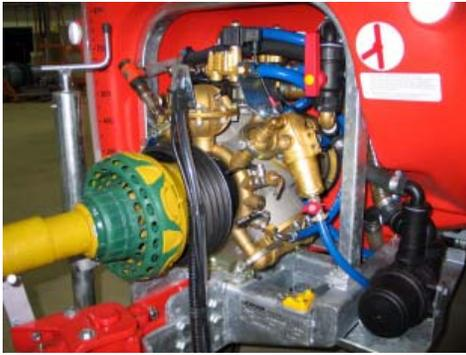
Vierkammer-Membranpumpe Comet IDS 1400. Antrieb über Teleskopgelenkwelle mit Zapfwellennormprofil und Durchtrieb.
