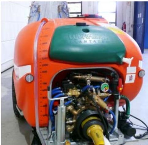
Abb. 4: Der Behälterfüllstand kann auch von vorn gut abgelesen werden.
