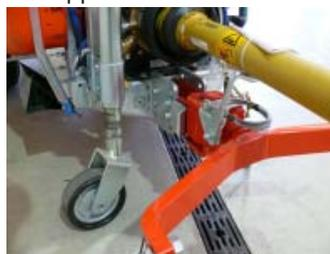
Abb. 3: Knickdeichsel, Gelenkwellenablage.
