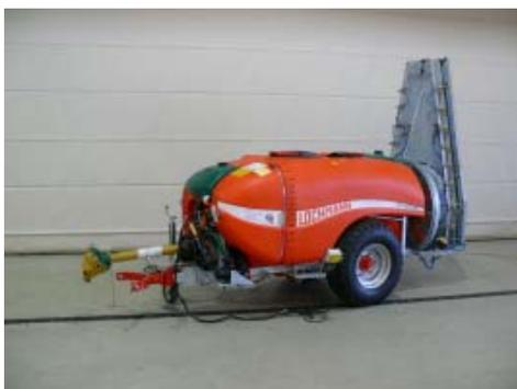
Abb. 2: Fahrgestell mit Knickdeichsel und Stützrad.
