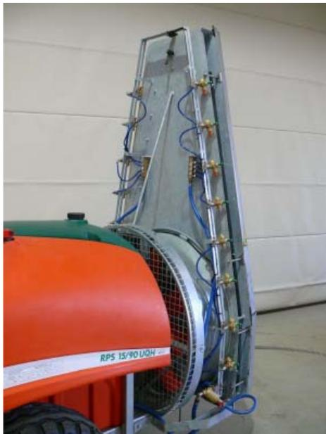
Abb. 5: Axialgebläse mit Querstromaufsatz und einseitiger Luftabdeckung.
