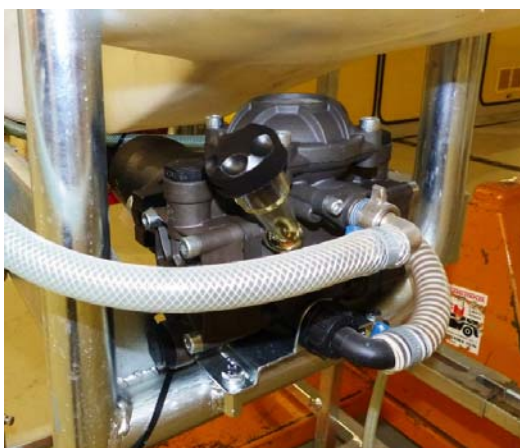
Bild 6: Die Pumpe AR 202 wird hydraulisch angetrieben.
