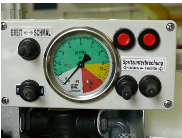
Bild 7: Schaltarmatur für die Fernbedienung des Gerätes. Der Spritzdruck muss vorher von Hand eingestellt werden.
