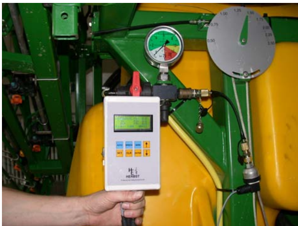
Abbildung 2: transportables Anzeigegerät mit Drucksensor.
