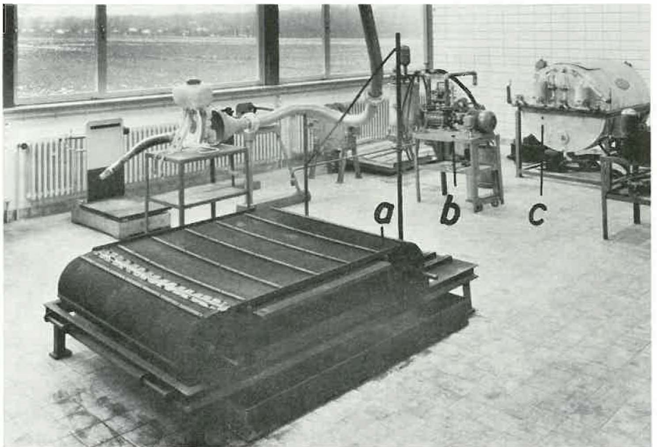
Abb. 10: Prüfeinrichtungen im Institut für Geräteprüfung in Braunschweig: a) Gerät zur Herstellung von Schnittbildern durch Düsenstrahlstrahle, b) Prüfstand für Einzeldüsen, c) Brühebehälter (mit Armaturen, Kühleinrichtung, Rührwerk) für Verschleißprüfungen.
