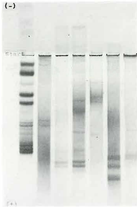
Abb. 7: Trennung von Proteinen aus Grassamen durch Polyacrylamid-Elektrophorese bei pH 8, 9. Kathode oben. Linke Bahn Proteine einer Kartoffelknolle LORI zum Vergleich, weitere Reihenfolge siehe Text.
