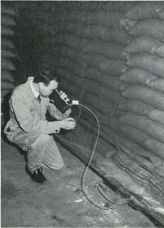
Abb. 3: Messung der Methylbromidkonzentration mit einem Interferometer bei einer Sackstapelbegangung unter Planen.
