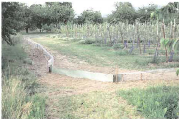
Migrationsbarriere mit flexiblem Tor aus Polyolefin-Folie am Versuchsstandort nahe Baden-Baden
