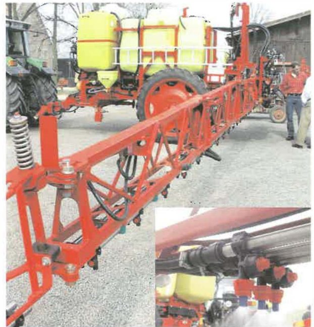
Feldspritzgerät (Prototyp) für die teilflächenspezifische Applikation verschiedener Pflanzenschutzmittel in einem Arbeitsgang
