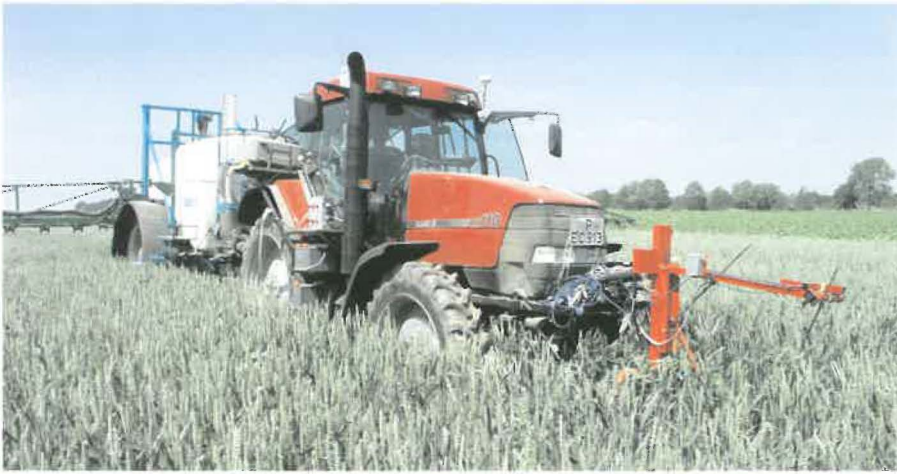
Pendelsensor (Frontanbau) zur Erfassung der Pflanzendichte in Getreidebeständen (Foto: ATB)
