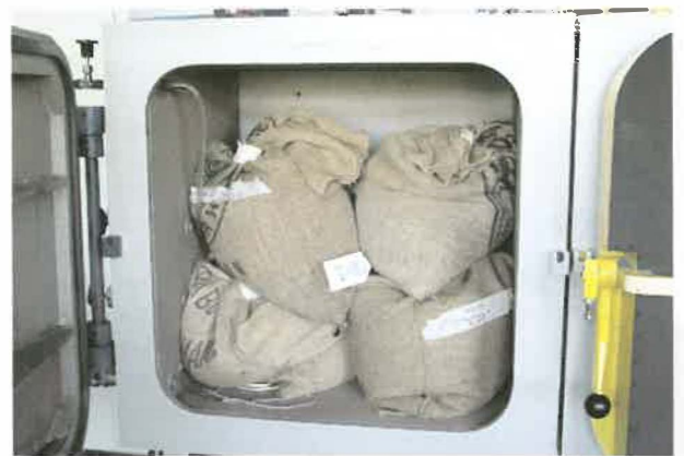
Begasung von Rohkakao in einer Begasungskammer
