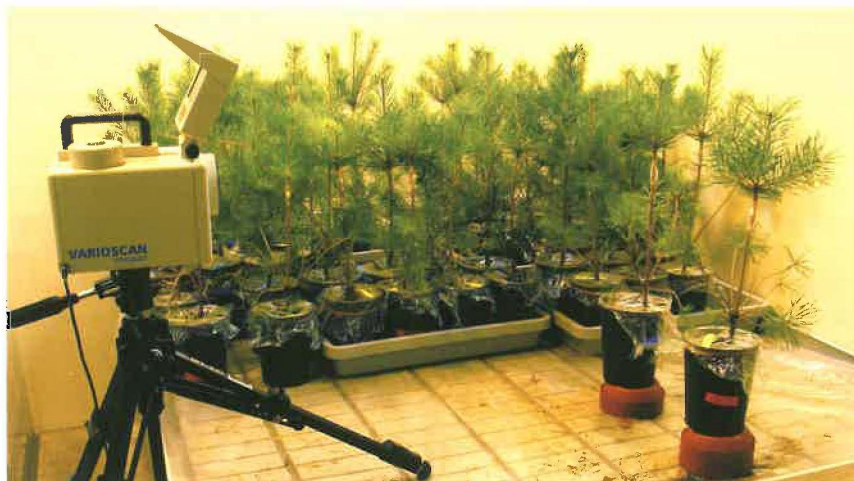
Nematodeninfizierte Kiefern im Fokus der Infrarot Thermokamera
