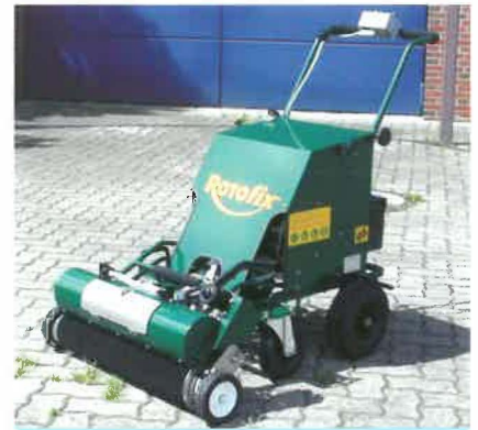
Walzenstreichgerät zur Unkrautbekämpfung im kommunalen Bereich
