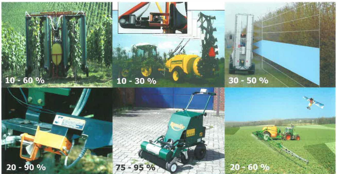
Beispiele für mitteleinparende Technik mit geschätztem Einsparungspotenzial. Oben: Recyclinggerät, Sensor-Sprühgerät, Zweistoffverfahren; unten: Unterstockspritzeinrichtung mit Gründetektor, Streichgerät, Feldspritzgerät für Teilflächenapplikation (v. l. n. r.)
