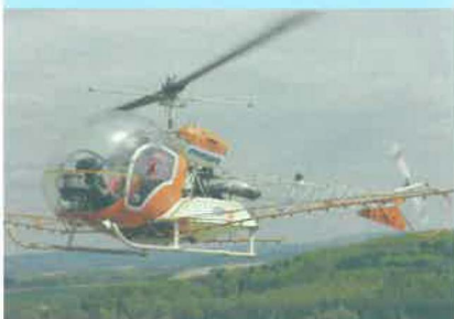
Hubschrauber mit Simplex-Spritzanlage beim Einsatz im Forst
