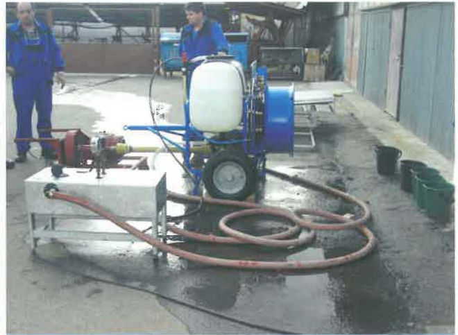
Messung des Pumpenvolumenstroms an einem Sprühgerät
