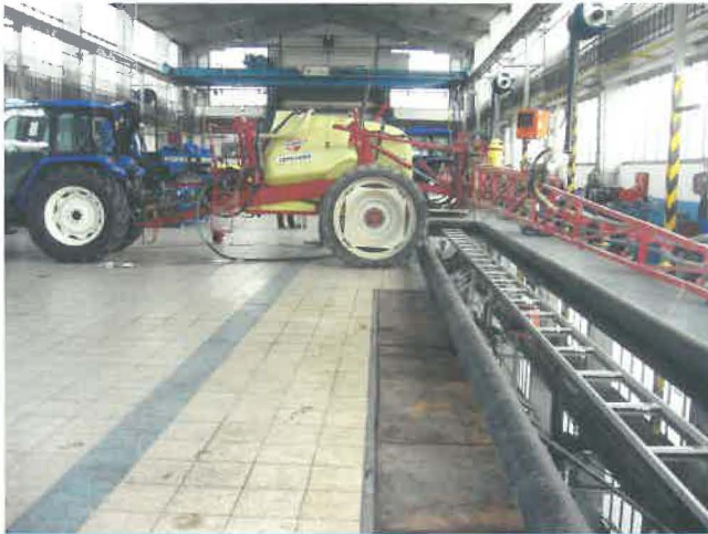
Querverteilungsmessung in tschechischem Kontrollbetrieb
