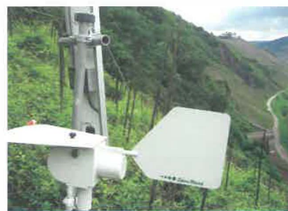
Sporenfalle in einer Driesche zum Fang von Ascosporen des Schwarzfäuleerregers
