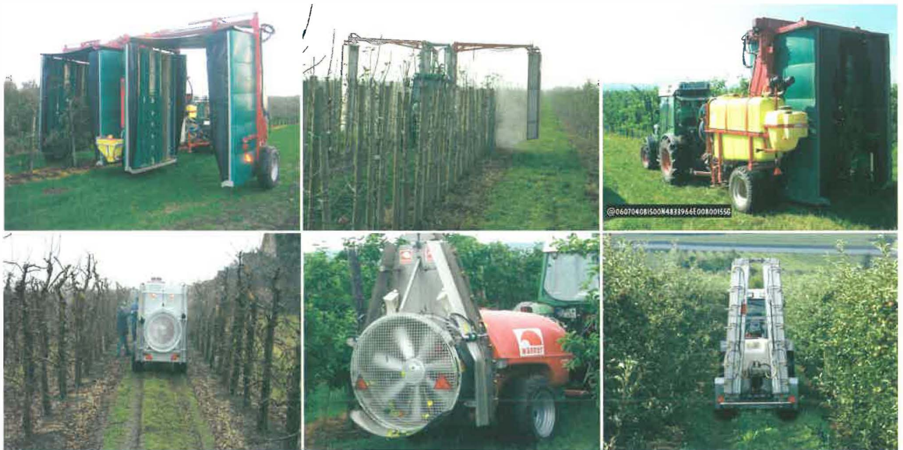
Obstbausprühgeräte mit Einrichtungen zur Abdriftminderung
