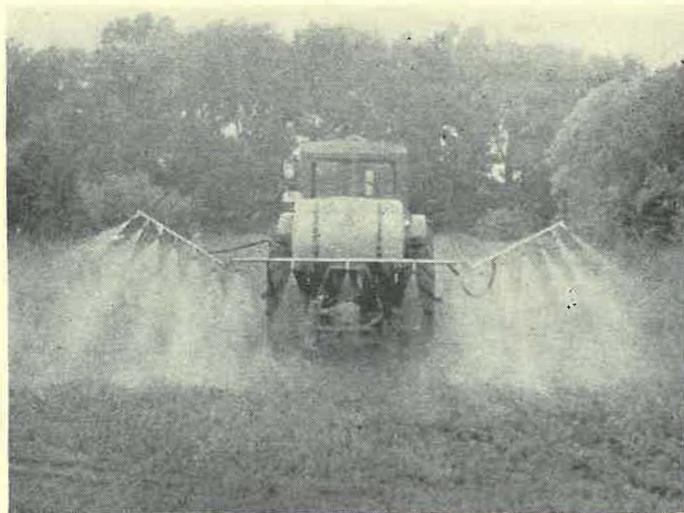
Abb. 3: Anbauspritzmaschine „Kertitox PK-4/9“
