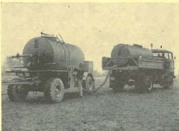
Abb. 1. Befüllen der mobilen Misch- und Beladestation (MB-Hänger - Typ Niederbobritzsch) am Feldrand mit Wasser (Foto: Gert Breidenstein, Freiberg/Sa.)
