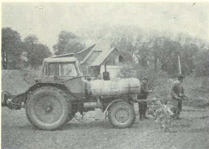
Abb. 1: Umgebautes Bandspritzgerät BS 12, Anordnung der Baugruppen für die Nachsaat- bzw. Nachauflaufspritzung
