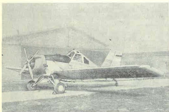
Abb. 1: Agrarflugzeug PZL 106 A mit Sprüh- und Spritzeinrichtung
