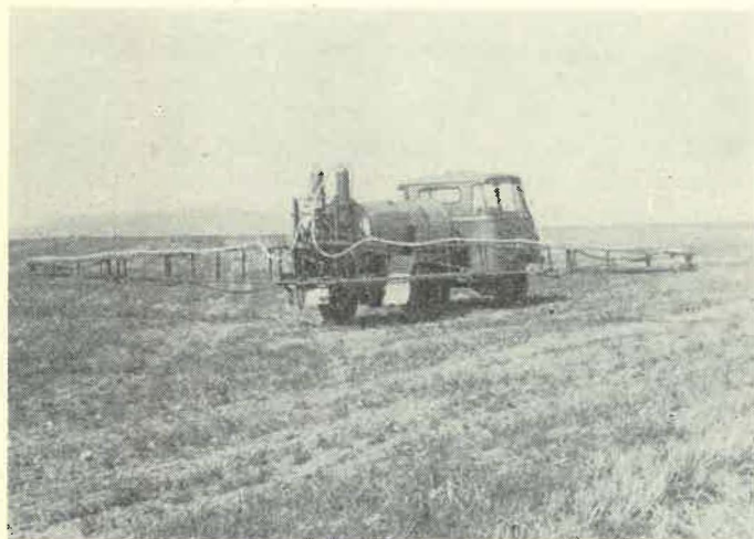
Abb. 2: LKW „Robur 1800 A“ mit aufgebauter Pflanzenschutzmaschine „Kertitox 2000“, Spritzgestänge in Arbeitsstellung
