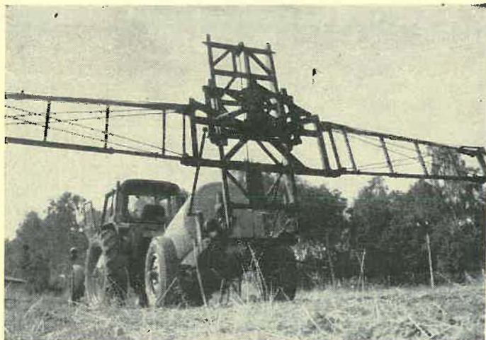
Abb. 2: Funktionsmuster der Ausleger-Pendelaufhängung mit Horizontalstabilisierung
