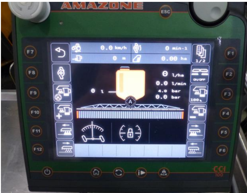
Abb.6: Anzeige und Einstellung der Spritz- und Hydraulikfunktionen am Terminal „AMATRON 3“ mit Monitor und Drucktasten.
