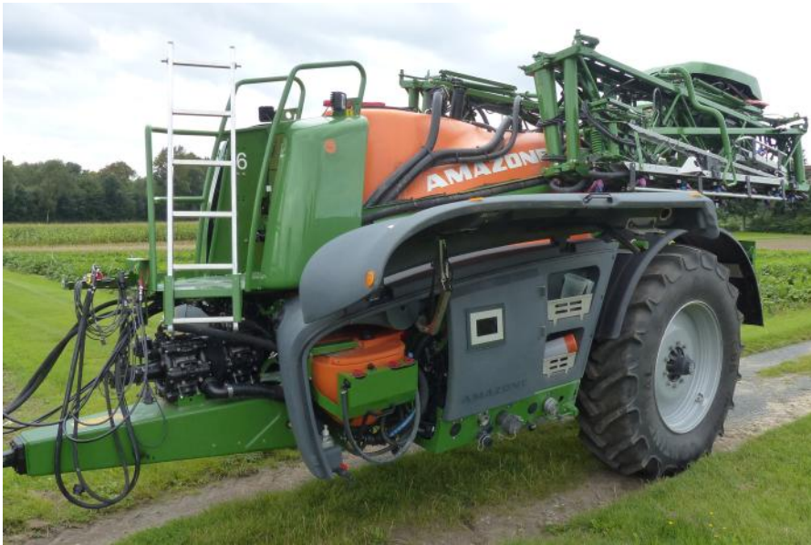
Abb.4: Linke Geräteseite: Einspülschleuse, Befüllanschlüsse und Bedienzentrum mit Touch-Monitor.
