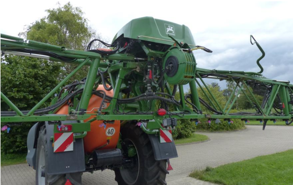
Abb.3: Zentraler Gestängebereich mit Lift, Ausrüstung zur Außenreinigung und Leuchten zur Sichtbarmachung der Spritzfächer bei Dunkelheit.
