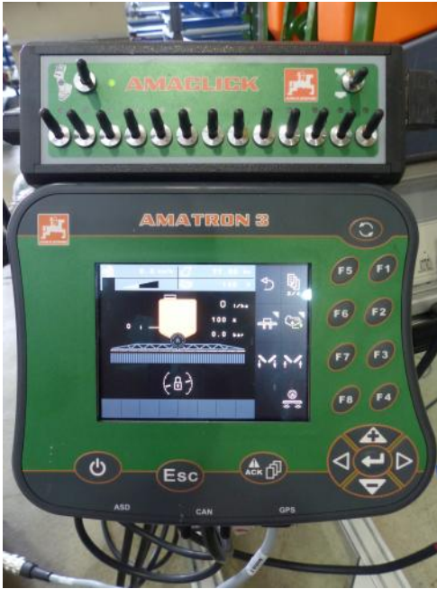
Abb.6: Anzeige und Einstelleinheit des „AMATRON 3“ Terminal mit Monitor und Schaltbrett zur Anzeige und Einstellung der Spritz- und Hydraulikfunktionen.
