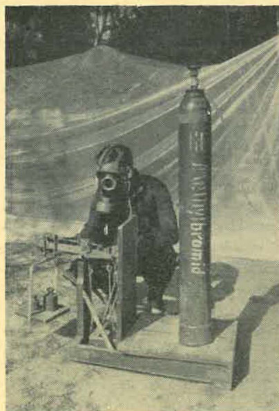
Abb. 5: Dosierung und Einführung von Methylbromid
